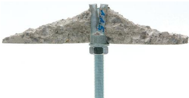
Bild 5.3: Betonausbruchkegel einer Einfachbefestigung
