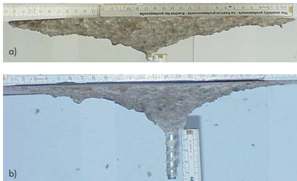
Bild 5.21: Betonausbruch bei geringer Verankerungstiefe a) h_{nom} = 50 \text{ mm} und b) h_{nom} = 90 \text{ mm} [2]
