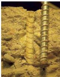
Bild 4.11: Schraubanker und ein in den Beton geschnittenes Gewinde [2]
