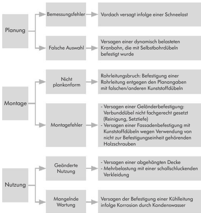
Bild 10.3: Fehlerbeispiele bei der Planung, Montage und Nutzung [23]
