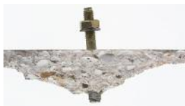
Bild 5.1: Betonausbruchkegel eines auf Zug beanspruchten Metallspreizdübels
